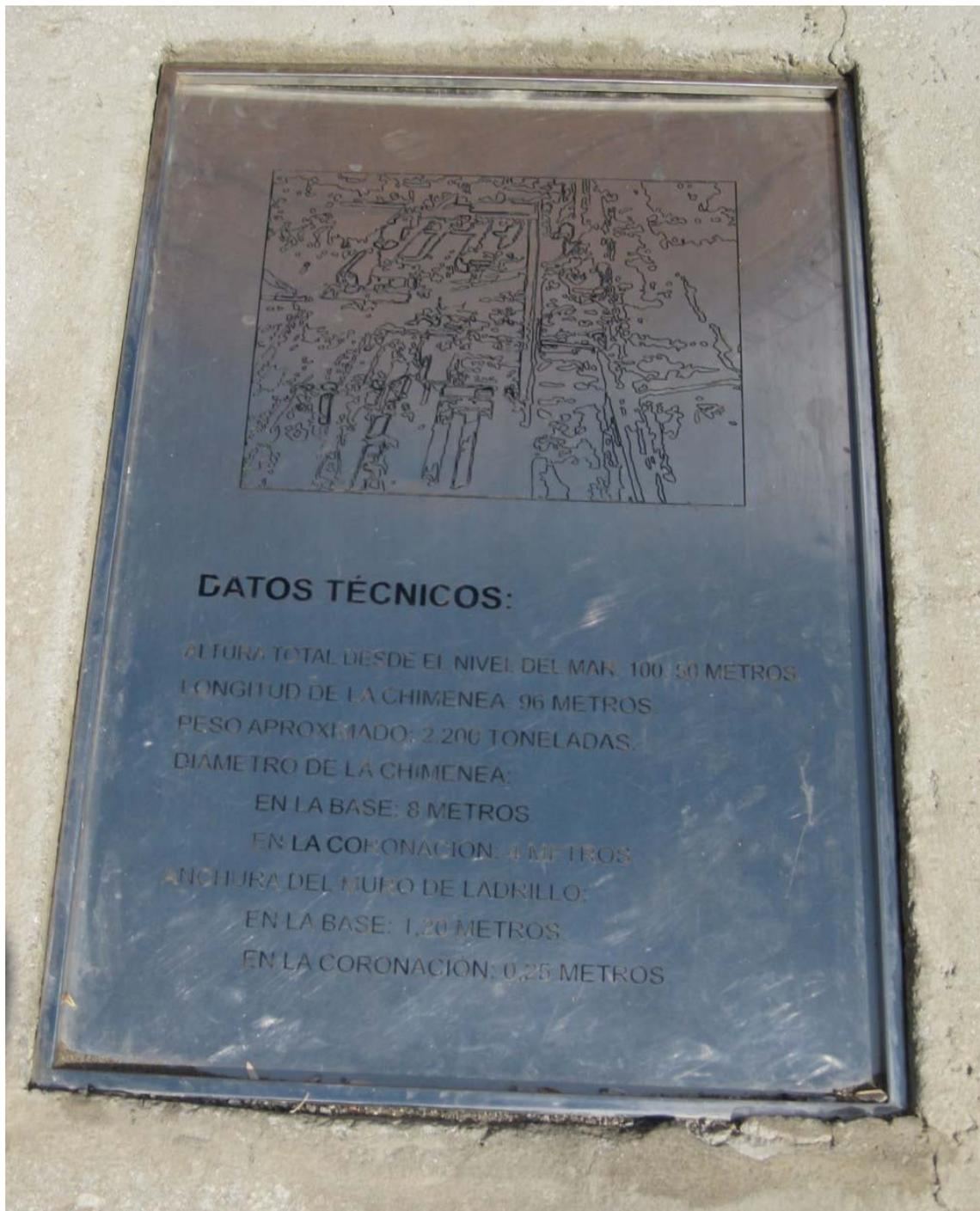
6. Ilustración: Placa con datos técnicos de la chimenea. Es importante llamar la atención a los alumnos que todo dispositivo técnico tiene que contar con una placa o etiqueta con los datos técnicos del dispositivo. Como ejercicio se plantea dibujar a escala la chimenea con estos datos y comprobar que se parece a las fotos.
