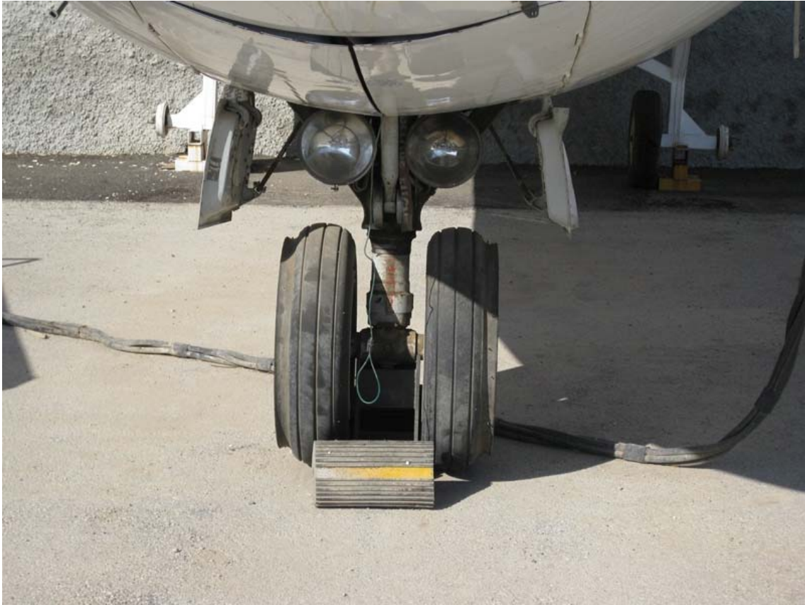
2. Ilustración: Tren de aterrizaje, con sus luces de aterrizaje. el detalle amarillo del calzo no es gratuito. En la noche es fácil no verlos.
