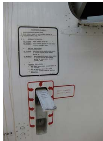
9. Ilustración: Mandos de la escalera. La línea roja determina área de peligro para los dedos.
