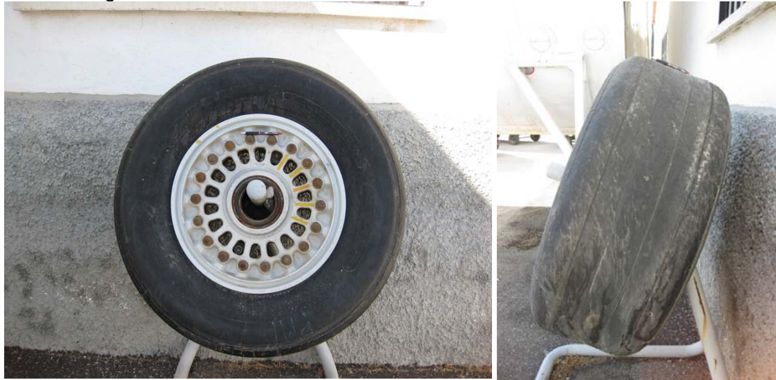
3. Ilustración: Rueda del tren trasero, vista lateral y frontal bolígrafo para dar idea del tamaño. Bastante gastada, en teoría tiene que tener rayas para desalojar el agua de las pista en caso de lluvia.
