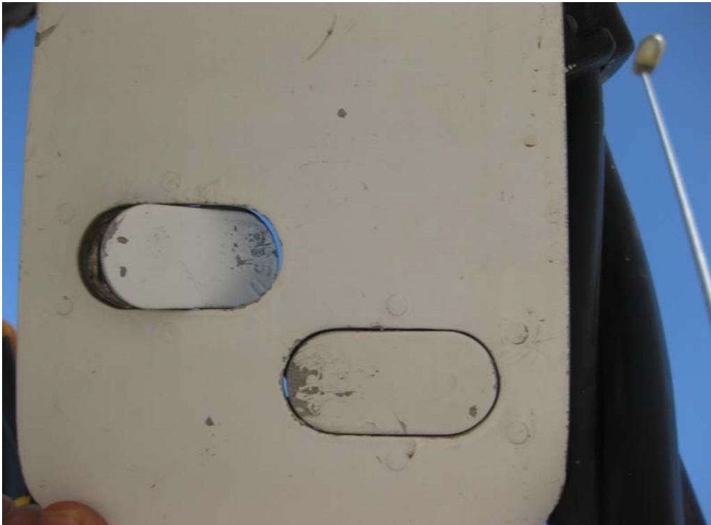
7. Ilustración: Vista exterior de la tapa de la toma eléctrica. Un broche abierto y otro cerrado. La apertura y cierre se hace con la presión del dedo. Al cierre la tapa queda lisa. Esto acelera las tareas de servicio enormemente, y las hace más seguras, al simplificarlas.
