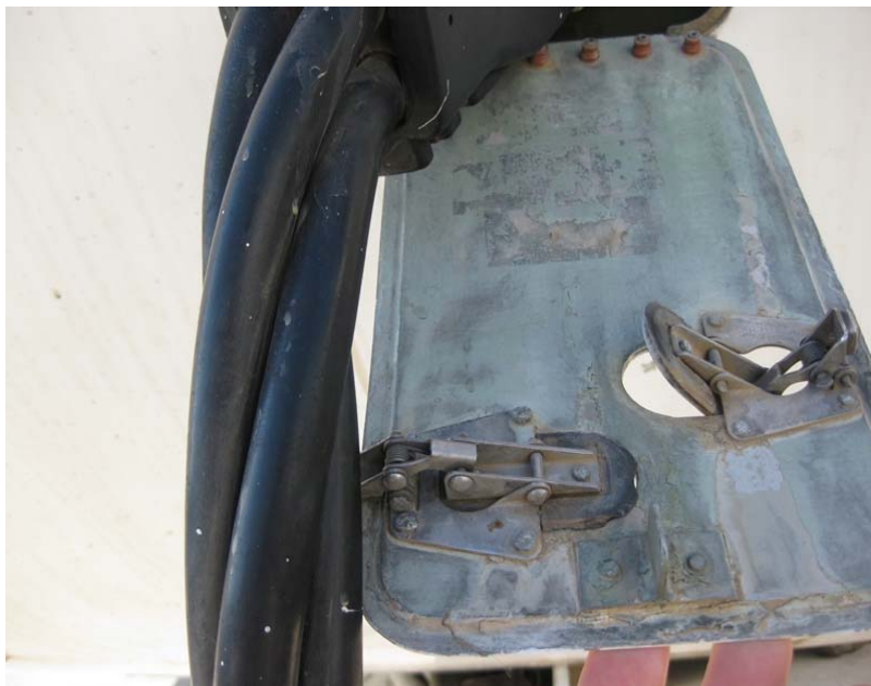
6. Ilustración: Detalle del mecanismo de cierre de la tapa de la toma de energía. Abre hacia fuera y abajo, con lo que se ahorra espacio y se ahorra la varilla de sujeción.
