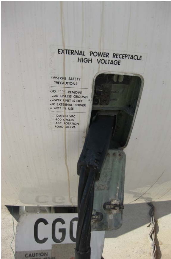
4. Ilustración: Aquí vemos la toma de corriente del avión. Notese que todos los elementos tienen una leyenda de seguridad y características.
