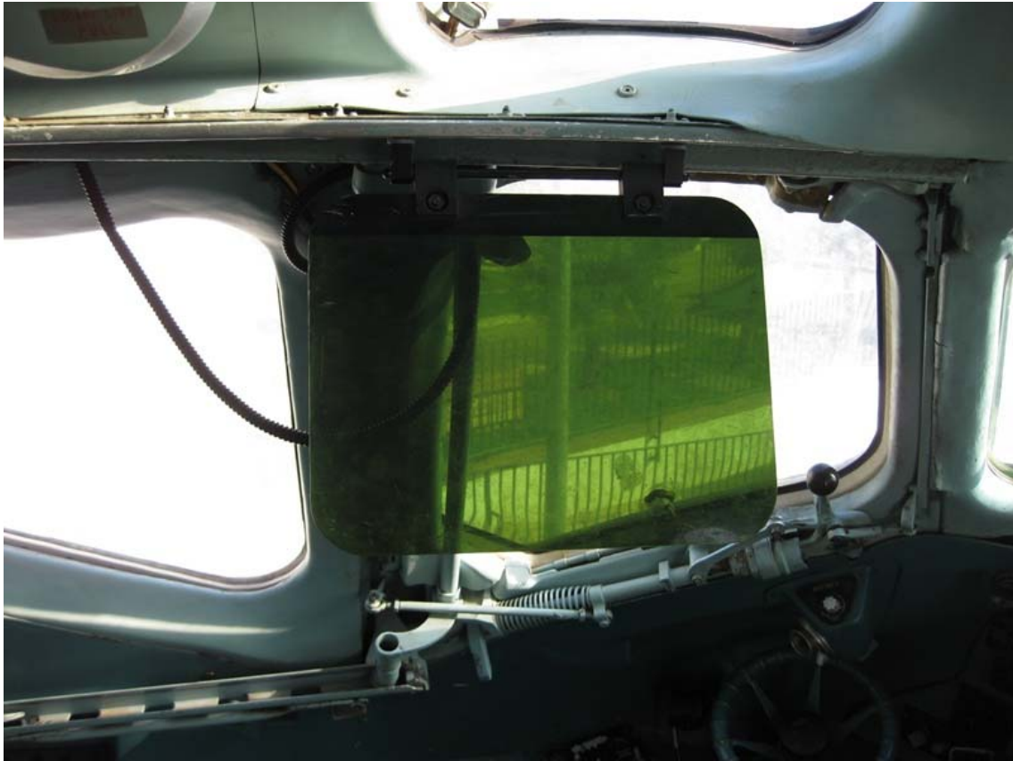
13. Ilustración: Visera polarizada para evitar deslumbramientos y ver a través del polvo. Observe cómo la cámara capta el exterior a través del cristal verde, mientras las ventanas (bastante sucias) aparecen blancas. En el momento de la foto el Sol estaba enfrente,
