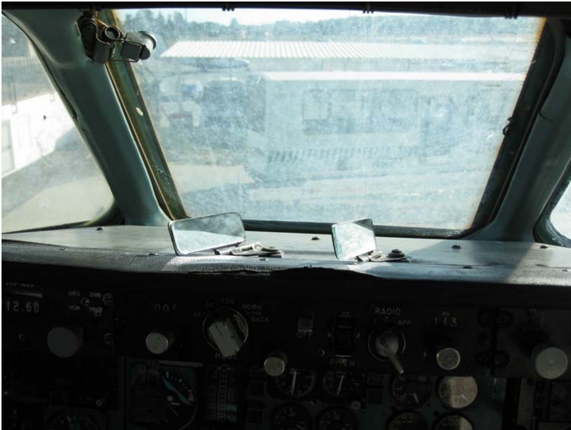
15. Ilustración: Unos humildes espejos permiten controlar las alas. Los motores iban en la cola.
