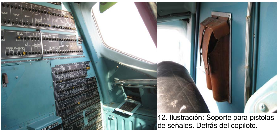
11. Ilustración: Cuadro de fusibles, a la espalda del comandante. La caja abierta es donde estaban los fusibles de repuesto.
